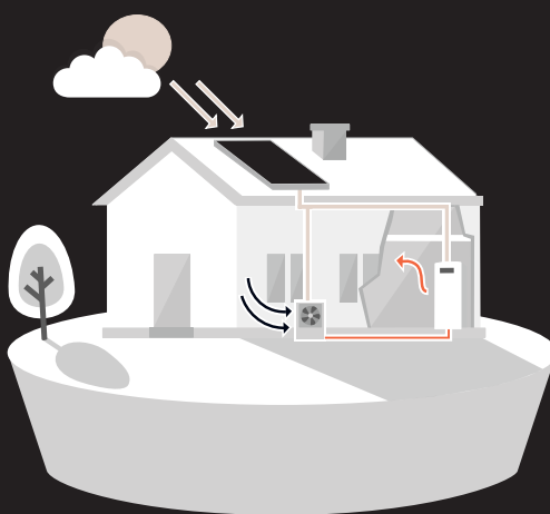
8. Solceller och värmepump
